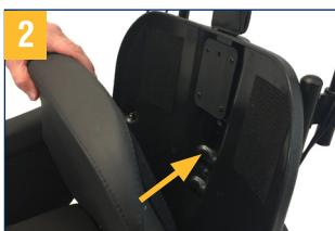
Het bijgeleverde rugkussen wordt met klittenband aan de rugplaat vastgemaakt. Controleer of het rugkussen goed aansluit.
