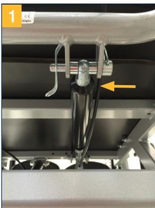
Stellen Sie die Rückenlehne aufrecht und befestigen Sie die Rückenlehne mithilfe des Verbindungsbolzens am Rahmenuntergestell. Schieben Sie den Verbindungsbolzen durch die Aufnahmen und sichern Sie den Bolzen mit der Verschlusslasche. Vergewissern Sie sich, dass der Bolzen fest verschlossen ist.
