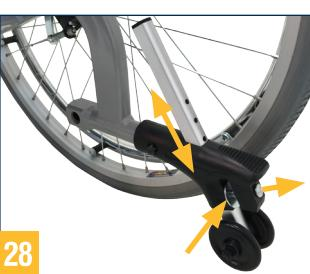
Les roues anti-basculement empêchent le fauteuil roulant de basculer vers l'arrière. Elles permettent également à l'auxiliaire de basculer plus facilement le fauteuil.
