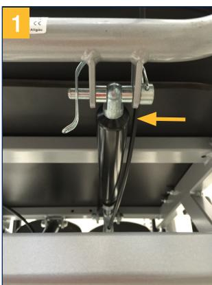
Zet de rugleuning rechtop en bevestig deze met de verbindingsbout op het onderstel van het frame. Schuif de verbindingsbout door de houders en borg de bout met de sluitlus. Controleer of de bout stevig is afgesloten.
