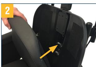
Das mitgelieferte Rückenpolster wird durch eine Klettverbindung an der Rückenplatte befestigt. Vergewissern Sie sich, dass das Rückenpolster bündig aufliegt.
