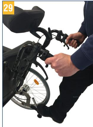
Les aides au basculement permettent à l'auxiliaire de basculer plus facilement le fauteuil roulant pour franchir des obstacles.
