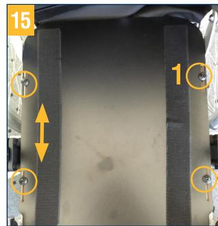
Demontieren Sie die Beinstützen und entfernen Sie das Sitzkissen.
