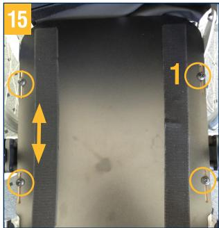
Resserrez ensuite solidement les vis de fixation.
