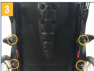
Pour régler la hauteur du dossier, desserrez les 4 vis à six pans creux des clameaux de fixation et déplacez le dossier jusqu'à la hauteur souhaitée puis resserrez les vis.
