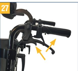
Als de rolstoel wordt geparkeerd, worden de remmen aan beide zijden geactiveerd door het indrukken van de remhendel. Schuif de parkeerhendel van de rem daarna omlaag, zodat deze de remhendel vergrendelt.
