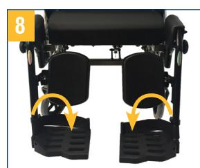
Nachdem Sie die Beinstützen eingesteckt haben schwenken Sie die Fußplatten nach unten.
