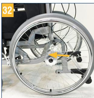
Avant de démonter les roues motrices, faites le nécessaire pour que le fauteuil roulant ne bascule pas.
