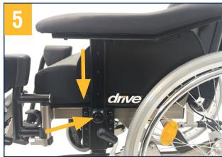
Appuyez sur le bouton de verrouillage et enfoncez les montants latéraux/acoudoirs à fond dans les supports prévus à cet effet (on doit entendre en clic).
