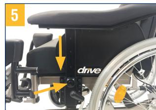
Drücken Sie den Arretierknopf und schieben Sie die Seitenteile/Armlehnen in die dafür vorgesehenen Halterungen bis sie eingearastet sind.
