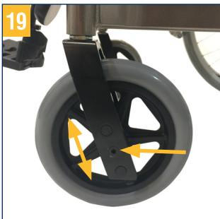
Verwijder de schroefbevestiging van de wielaar en trek deze eruit.
