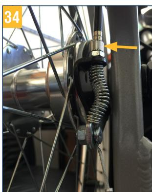
Voor een optimale werking van de rem wordt de remkracht afgesteld bij de instelschroef.
