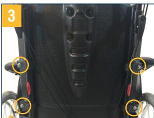
Zur Einstellung der Rückenlehnenhöhe lösen Sie die 4 Inbusschrauben der Halteklemmern und verschieben die Rückenlehne in die gewünschte Position, Schrauben wieder festziehen.
