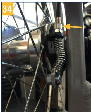
Pour obtenir un freinage optimal, ajustez la force de freinage au moyen de la vis de réglage.
