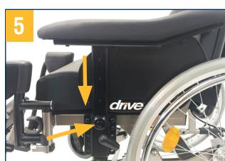
Druk op de vergrendelknop en schuif de zijpanelen/armleuningen in de daarvoor bedoelde houders totdat ze zijn vergrendeld.
